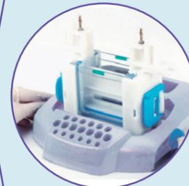
**Módulo com sistema de travas que dispensa parafusos.**
